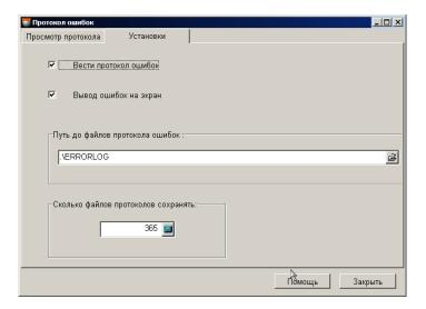
На экране окно с установками для ведения протокола ошибок. Система при работе может вести специальный файл ГодМесяцДень.log, в который записываются возникающие при работе системы ошибки. Этот файл служит для поиска и устранения неполадок сервисной службой.
