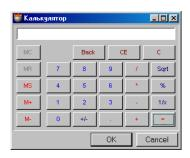
На экране окно калькулятора. Калькулятор позволяет производить четыре арифметических действия, вычислять квадратный корень и процент. В калькуляторе также есть память с возможностью суммирования и вычитания. Для работы с калькулятором можно воспользоваться как мышкой, так и цифровой клавиатурой компьютера.
