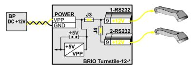
**ВАРИАНТ 3.** Кабель сканнеров не позволяет подавать напряжение питания на сканнер через **9-й контакт** разъема. Используются блоки питания самих сканнеров. Перемычки **J3** и **J4** могут быть в любом состоянии.
