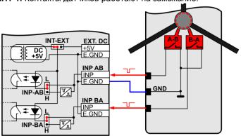
Контакты выходов датчиков A-B(B-A) турникета подключаются ко входам INP-AB (BA) так, как показано на рисунке. Перемычки INP-AB (BA) должны быть установлены в положение L, а перемычка INT-EXT в положение INT.
