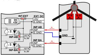
• Контакты выходов датчиков **A-B(B-A)** турникета подключаются ко входам **INP-AB (BA)** так, как показано на рисунке. Перемычки **INP-AB (BA)** должны быть установлены в положение **H**, а перемычка **INT-EXT** в положение **INT**.
