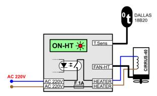
Контроллер считывает показания с датчика температуры, подключенного к разъему T-Sens.
