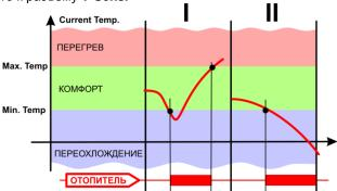
В зависимости от значения измеренной температуры (Current Temperature) и запрограммированных температурных порогов (Max. Temperature <sup>0</sup>C и Min. Temperature <sup>0</sup>C) модуль включает или выключает нагревательный элемент и вентилятор отопителя.
