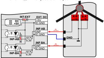
• Контакты выходов датчиков **A-B(B-A)** турникета подключаются ко входам **INP-AB (BA)** так, как показано на рисунке. Перемычки **INP-AB (BA)** должны быть установлены в положение **H**, а перемычка **INT-EXT** в положение **INT**.
