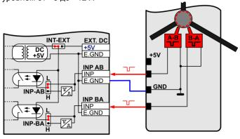
Контакты выходов датчиков A-B(B-A) турникета подключаются ко входам INP-AB (BA) так, как показано на рисунке. Перемычки INP-AB (BA) должны быть установлены в положение L, а перемычка INT-EXT в положение INT. **ВАРИАНТ 4.** По какой либо причине, питание (От +5 до +12V) на интерфейс датчиков модуля нужно подавать с турникета.
