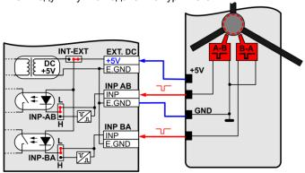
• Контакты выходов датчиков A-B(B-A) турникета подключаются ко входам INP-AB (BA) так, как показано на рисунке. Перемычки INP-AB (BA) должны быть установлены в зависимости от сигнала на выходе датчиков турникета. Перемычка INT-EXT в положение EXT.
