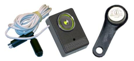
Считыватель предназначен для использования в составе POS систем. Данные, считанные с приложенной микросхемы памяти iButton  $(\mathbb{R})$ , передаются в компьютер по клавиатурному интерфейсу (PS/2). Встроенный коммутатор позволяет использовать считыватель одновременно с подключенной клавиатурой компьютера. Считыватель закрепляется при помощи липкой ленты в удобном месте на корпусе POS-а
