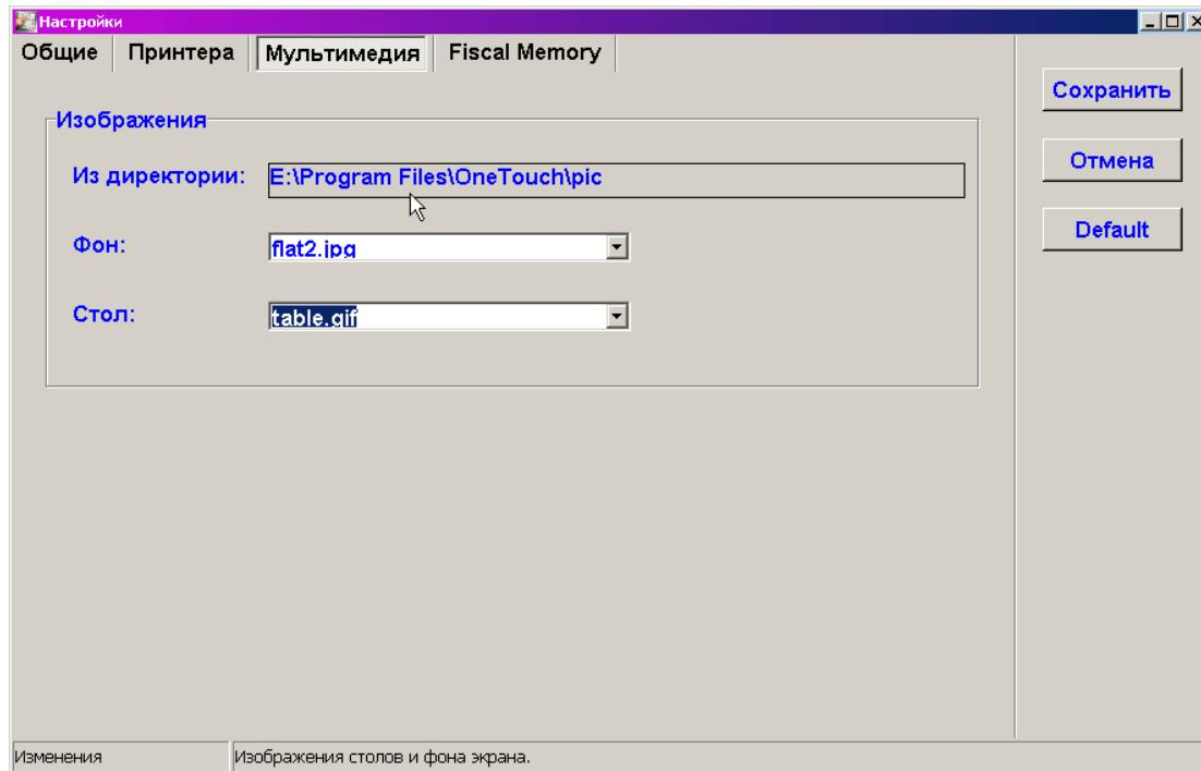
На экране окно дополнительных настроек терминала, открытое на закладке "Мультимедиа". В этом окне производится настройка картинок для изображения залов и столовиков. Формат файлов может быть \*.jpg, \*.gif, \*.bmp. Размер картинок может быть любым, при загрузке программно обеспечение терминала автоматически масштабирует их.
