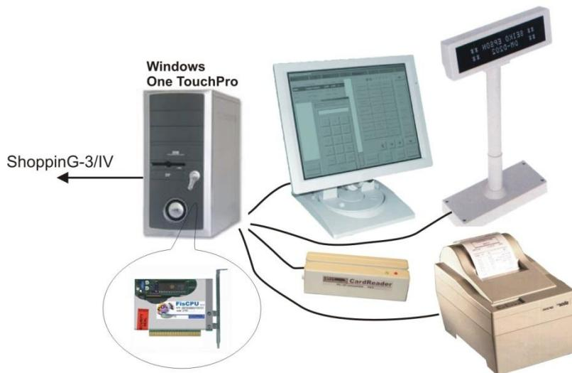
На рисунке представлена одна из возможных конфигураций терминала OneTouchPro, оптимизированная для работы в качестве терминала официанта и POS-а.
