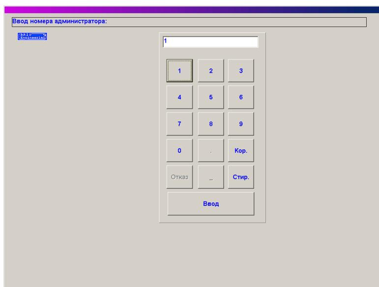
На экране запрос на ввод номера администратора. Номера администратора и их полномочия устанавливаются в системе Shopping-3/ IV. Ввод номера можно осуществить с клавиатуры, непосредственно на дисплее терминала, или воспользовавшись идентификационной магнитной картой.
