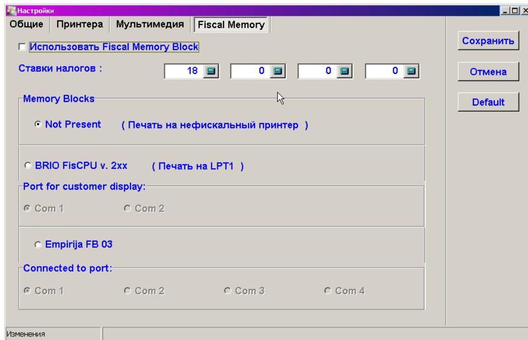
На экране окно дополнительных настроек терминала, открытое на закладке "Fiscal Memory". В этом окне производится настройка подключенного фискального модуля, если терминал используется в режиме POS-а.
