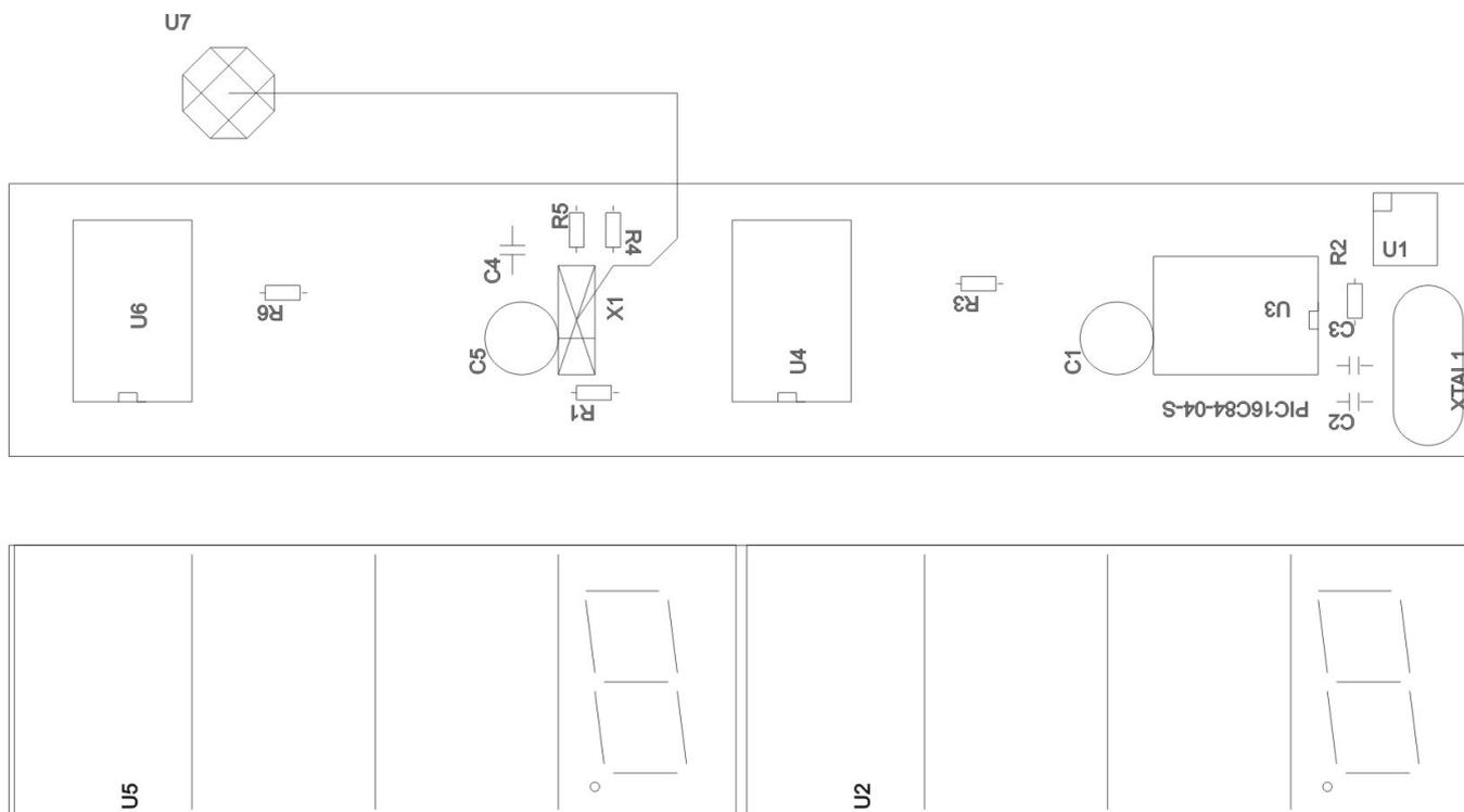
10.10. БЛОК УПРАВЛЕНИЯ ПРИНТЕРОМ (СХЕМА ПРИНЦИПИАЛЬНАЯ)
