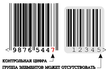
Сканнер следует запрограммировать таким образом, что бы контрольная цифра считывалась, но **не передавалась** в систему. При этом многие сканнеры считывают ее и используют для внутреннего контроля.
