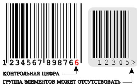
Сканнер следует запрограммировать таким образом, что бы контрольная цифра считывалась, но **не передавалась** в систему. При этом многие сканнеры считывают ее и используют для внутреннего контроля.
