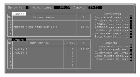
При работе кассового аппарата автономно, не в составе компьютерной системы (OFFLINE), его работа его работа будет определяться тем, как он был предварительно запрограммирован.
