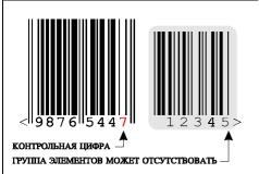
Сканнер следует запрограммировать таким образом, что бы контрольная цифра **передавалась** в систему. При этом многие сканнеры считывают ее и используют для внутреннего контроля.
