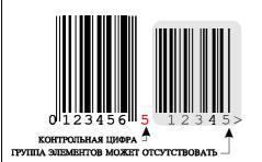
Сканнер следует запрограммировать таким образом, что бы контрольная цифра <u>передавалась</u> в систему. При этом многие сканнеры считывают ее и используют для внутреннего контроля.
