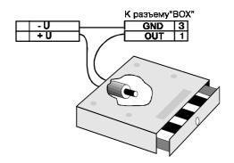
К кассовому аппарату можно подключить денежный ящик любой конструкции. Управление денежным ящиком осуществляется с выхода OUT разъема"BOX". (Открытый коллектор мощного транзисторного ключа)
